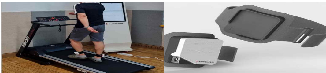
<그림 2> 발목형 센서 보행 측정 장비(Smart Balance)
